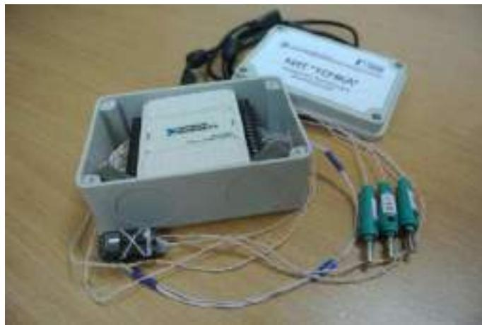
Рисунок 3.3 – Устройство контактной термометрии
