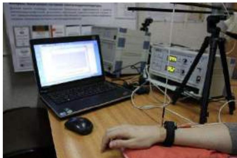
Рисунок 3.9 – Эксперимент по сравнению чувствительности к артефактам двух способов расположения световодного зонда анализатора «ЛАКК-02»
