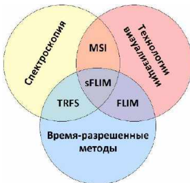
Рисунок 1.2 – Методы флуоресцентного детектирования: FLIM – визуализация времени жизни флуоресценции, TRFS – время-разрешенная флуоресцентная спектроскопия, MSI – многоспектральная визуализация, sFLIM – спектрально-разрешенный FLIM
